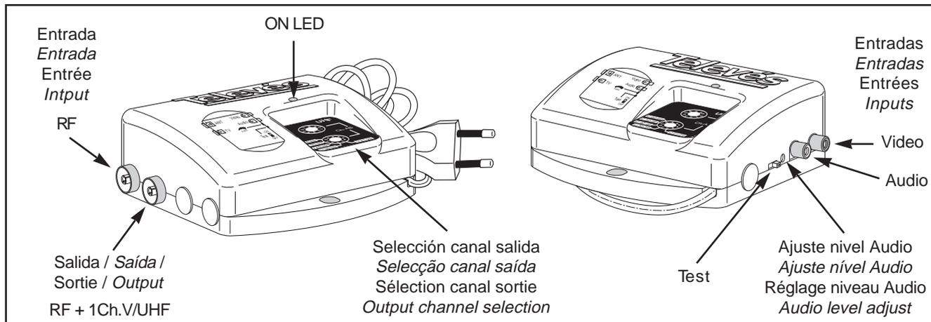
Modulador disponible en dos modelos en función de la banda de trabajo, que permite introducir una señal de audio y video modulada en la instalación interior de la vivienda. Especialmente indicado para distribuir la señal del receptor de TV DIGITAL a todas las tomas.
