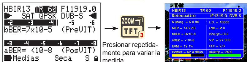
21.1 Ejemplo de visión simultánea Display/TFT de la medida Noise Margin del transponder de satélite.
