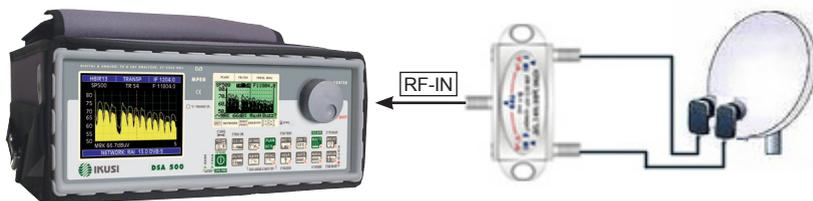
Fig. 12.2 Esquema de conexión del Switch DiSEqC-SWI-1-0-1.
